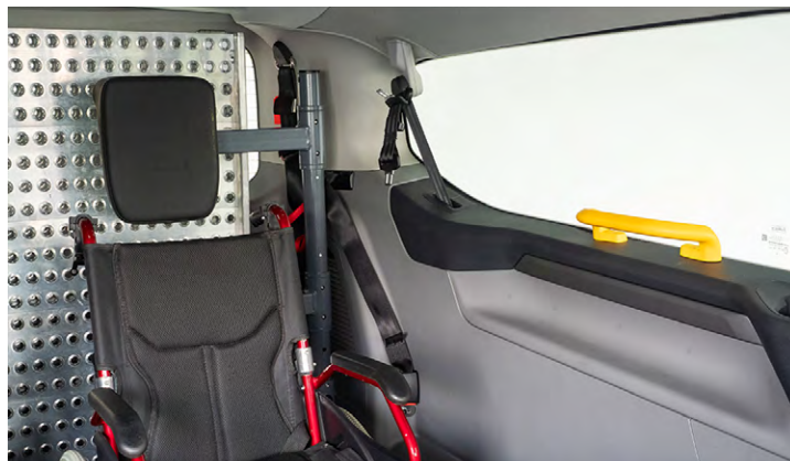
Asidero en zona PMR.
