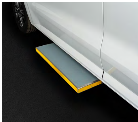
Peldaño lateral eléctrico: En PHEV de 600mm / en térmica 900mm
